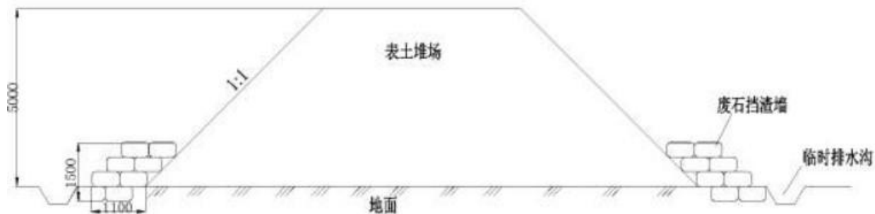
图 9-3 表土堆场干砌石挡墙结构尺寸图
