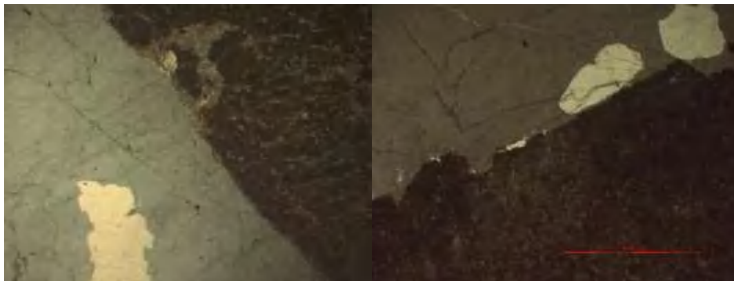
图 6-5 薄片 B8 混合矿镜下照片
