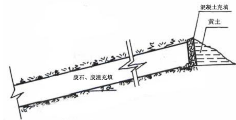
图 7.5-2 混合斜井回填封堵示意图
