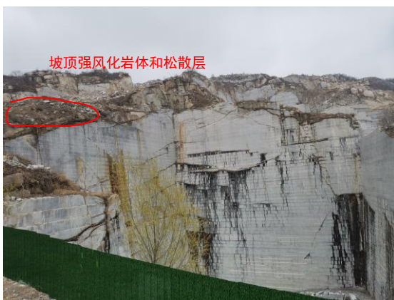
照片 5-1 露天采场形成高陡边坡
