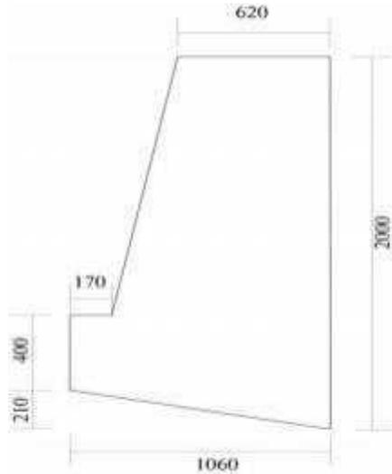
图 8-3 挡土墙断面示意图 (单位: mm)
