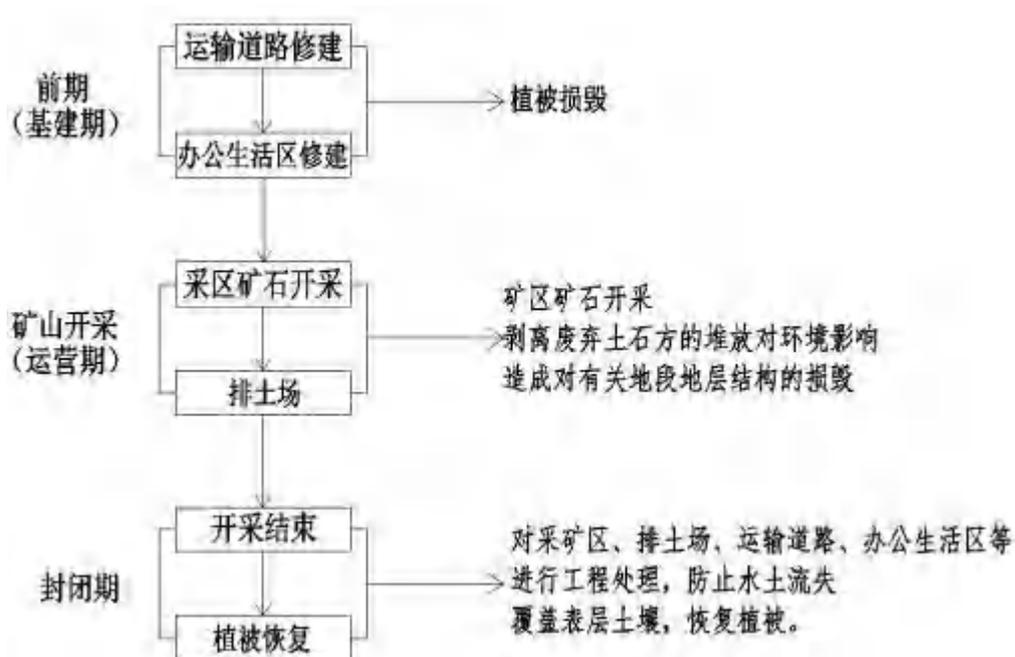
图 6-1 矿区开采工艺及损毁流程
