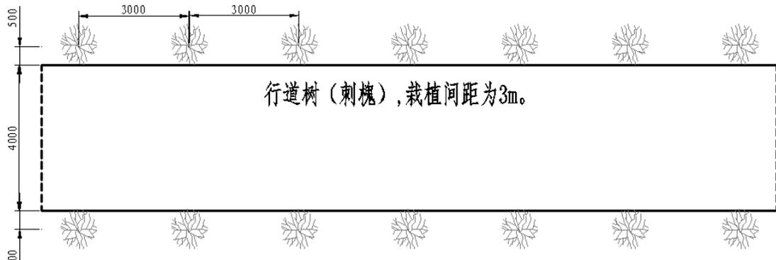
图 9-9 行道树栽植平面图
