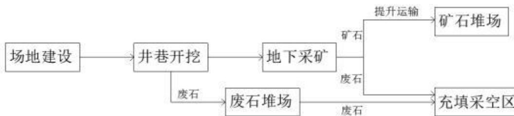
图 5-3-1 地采工艺流程图
