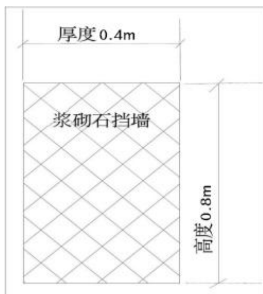
图 7-4 挡土墙断面示意图
