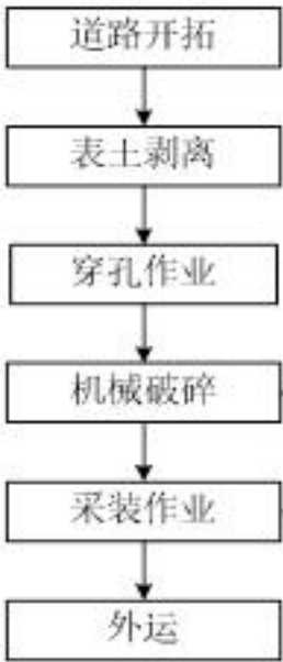
图 6-1 露采工艺流程
