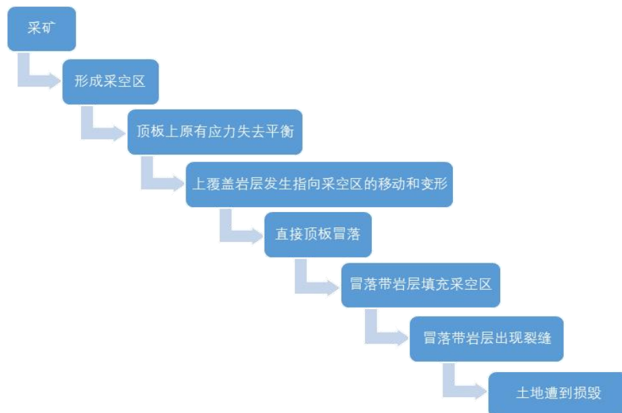
图 7-2 塌陷损毁时序图
