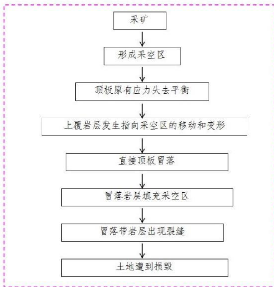
图 7.2-3 地面沉陷损毁时序图
